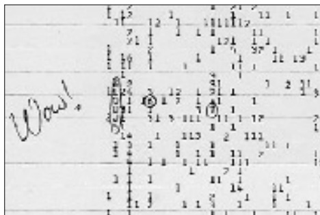
Figura 1.2. Il famoso segnale “Wow!” captato la sera del 5 agosto 1977 dal radiotelescopio Big Ear dell’Università dell’Ohio. I numeri e le lettere sul tabulato sono un codice usato per rappresentare l’intensità del segnale.
